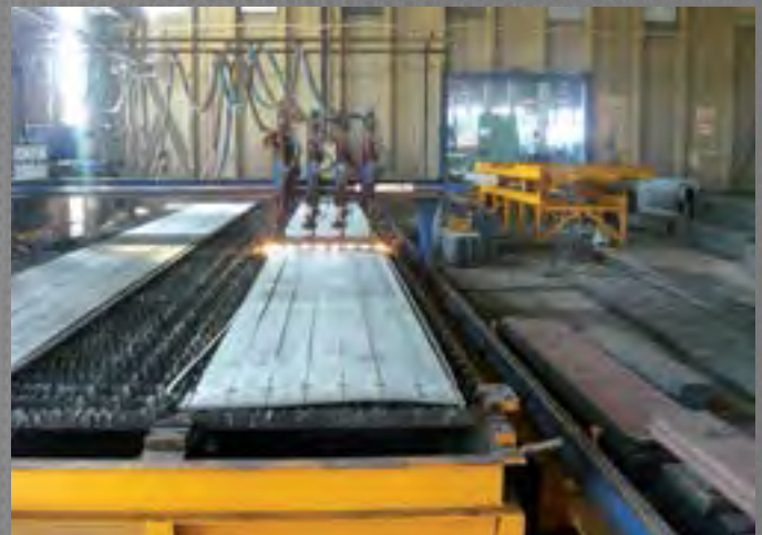
CNC Oksijen Kesim Makinası / CNC Oxygen Cutting Machine Comptoir d'oxycoupage CNC / CNC mit Sauerstoff funktionierende Schneidetisch ЧПУ кислородное устройство для резки / المقاعد الخاصة بالقطع بالأكسجين
