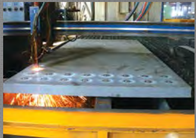
CNC Oksijen Kesim Makinası / CNC Oxygen Cutting Machine Comptoir d'oxycoupage CNC / CNC mit Sauerstoff funktionierende Schneidetisch ЧПУ кислородное устройство для резки / المقاعد الخاصة بالقطع بالأكسجين
