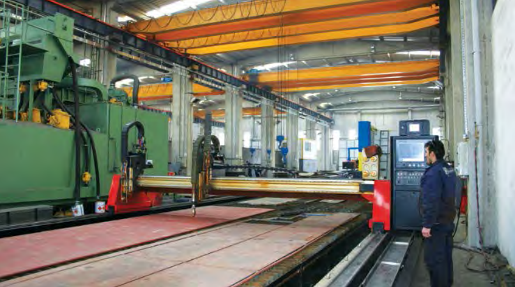
CNC Plazma Kesim Makinası / CNC Plasma Cutting Machine / Comptoir de découpe plasma CNC / CNC Plasma Schneidetisch Станки плазменной резки / المقاعد الخاصة بقطع البلازما
