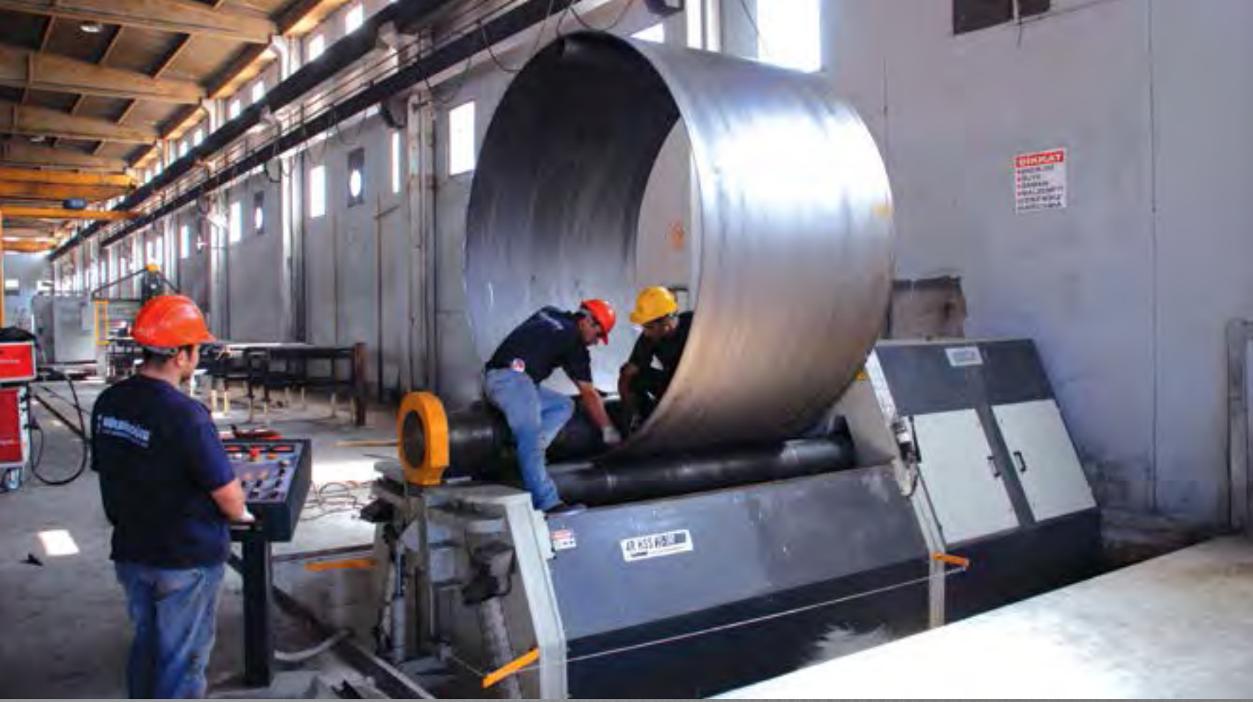
4 Toplu Silindir / 4 Roll Bending Machine / 4 Rouleau ensemble / 4 Mantel Zylinder / 4-х ролонный цилиндр / 4 تجمعات اسطوانية
