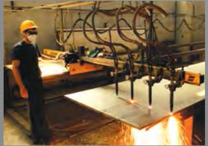
Oksijen Gazlı Optik Kesim Makinası Oxyfuel Optical Cutting Machine Comptoir Optique d'oxycoupage de gaz Mit Sauerstoff funktionierende optische Schneidetisch Кислородный газовый оптический аппарат для резки المقاعد الخاصة بالقطع البصري المحتوي على غاز الاوكسجين
