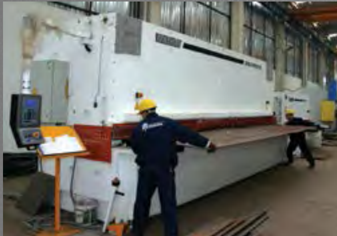
3m ve 6m Hidrolik Makaslar 3m and 6m of Hydraulic Shears 3m et 6m Cisailles hydrauliques 3m und 6m hydraulische Scheren 3м и 6м гидравлические ножницы الافئعة الهيدروليكية 3 م و 6 م
